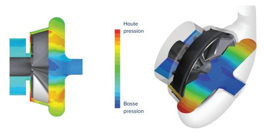
La roue encastrée crée un vortex qui agite la boue autour de la succion pour maintenir les solides en suspension.
