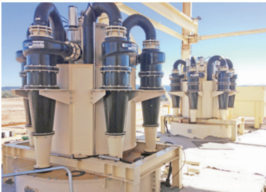
Гидроциклоны gMAX поставляются в типоразмерах от 6 дюймов до 20 дюймов в диаметре
