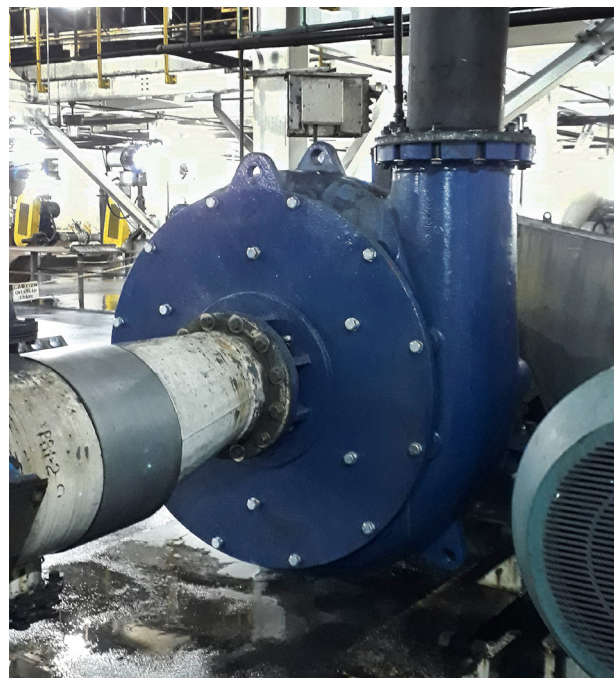
Nuestra bomba gravelMAX™ en una aplicación de alimentación de objetos pesados en ciclones para el proceso de carbón.
