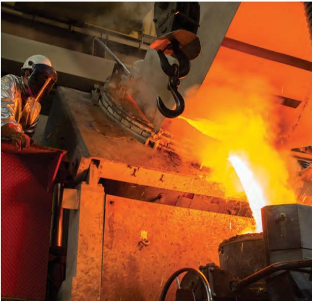
Vaciado de bronce estándar desde el horno al crisol en nuestra fundición para componentes EXCEL™, ubicada en Pekín, Illinois, EE. UU.
