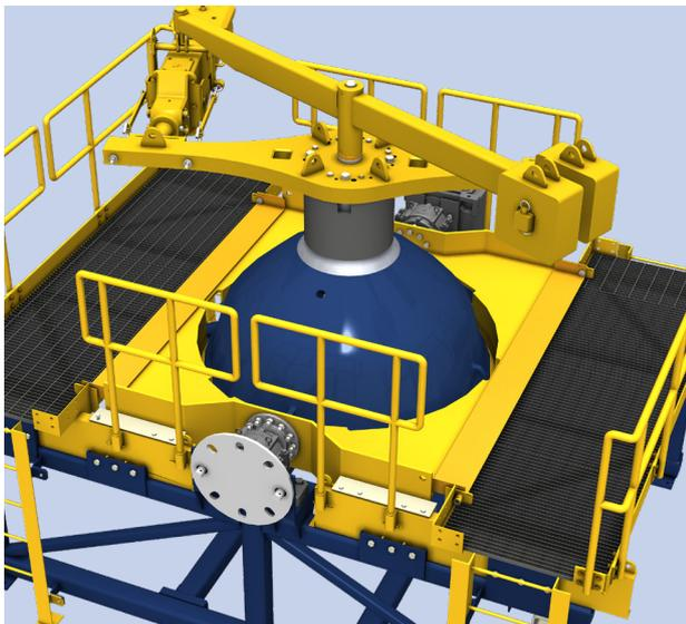
La plataforma de mantenimiento del cabezal es solo una de nuestras soluciones para su chancador. Contáctese con nuestros técnicos en chancadores de FLS para obtener más información sobre la herramienta para elevación de revestimiento de campana y sobre nuestra herramienta de apriete de cabezal.
