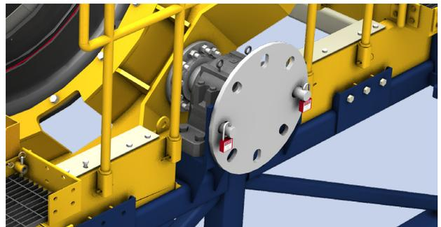
Mesa rotatoria impulsada por una caja reductora para una rotación completa y en 360°
