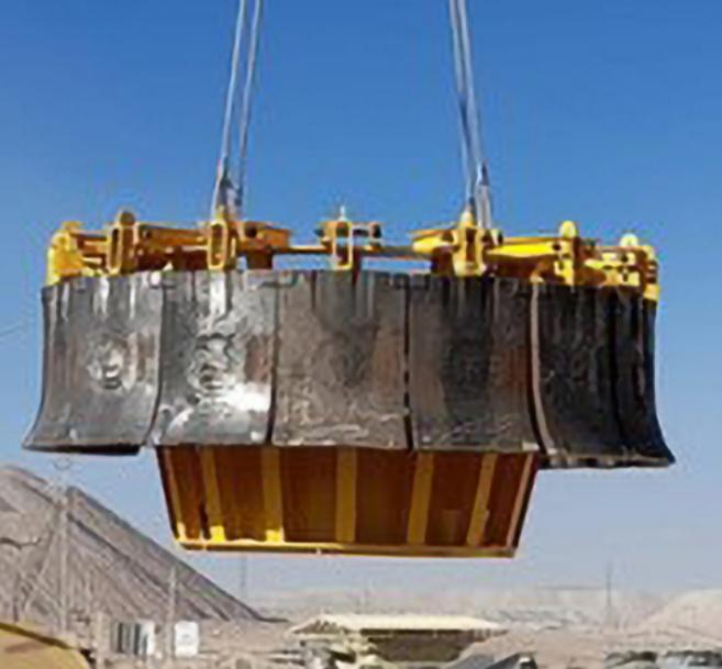
Os carrosséis permitiram que os revestimentos fossem posicionados antes do início da parada, prontos para serem abaixados no britador para fácil instalação. Como resultado, a duração da parada foi reduzida em 8 horas na primeira tentativa.
