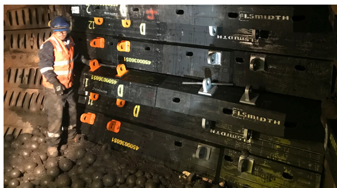
Revestimentos FLSmidth PulpMax instalados simultaneamente com os revestimentos do concorrente.
