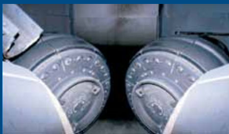
Вид валков внутри мельницы ОК
