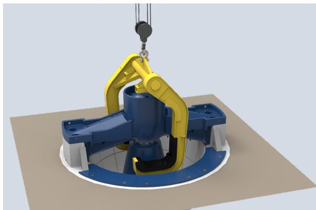
1. El gancho de elevación para la araña desciende sobre el conjunto de la araña
