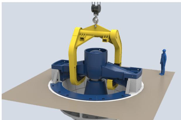
2. Gancho de elevación para araña en posición para elevación
