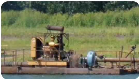
12 x 10 Dredge Sand Slurry
