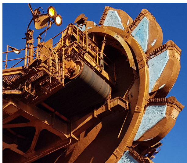
WEAR MAX® aplicado a las superficies de desgaste de un balde de un recuperador
