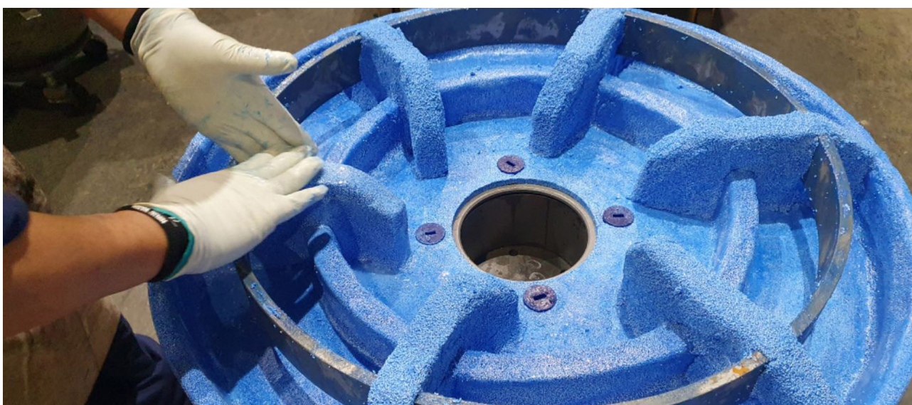
WEAR MAX® se puede aplicar a todas las superficies del distribuidor de alimentación de una centrífuga.
