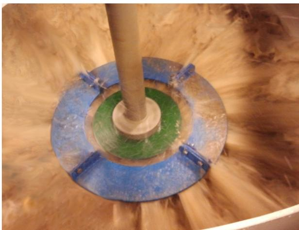
Los anchos chorros de flujo generados por el rotor nextSTEP y el patrón cruzado patentado del estator nextSTEP con ranuras aumentan las probabilidades de flotación.
