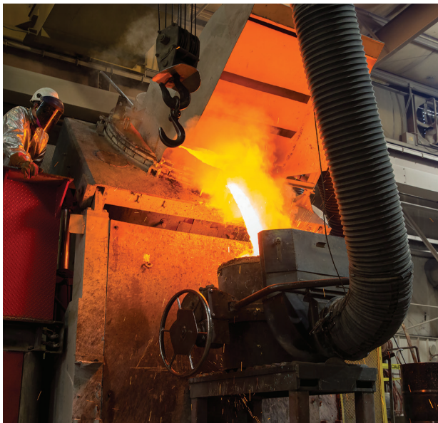
Vaciado de bronce estándar desde el horno al crisol en nuestra fundición para componentes EXCEL™, ubicada en Pekin, Illinois, EE. UU.
