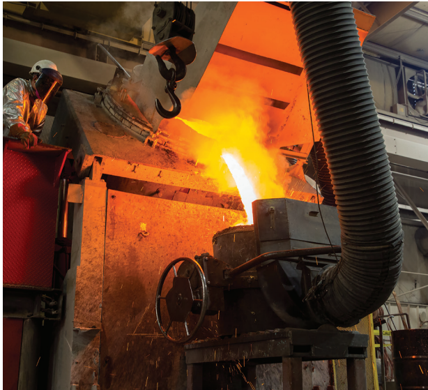
Vaciado de bronce estándar desde el horno al crisol en nuestra fundición para componentes EXCEL™, ubicada en Pekin, Illinois, EE. UU.
