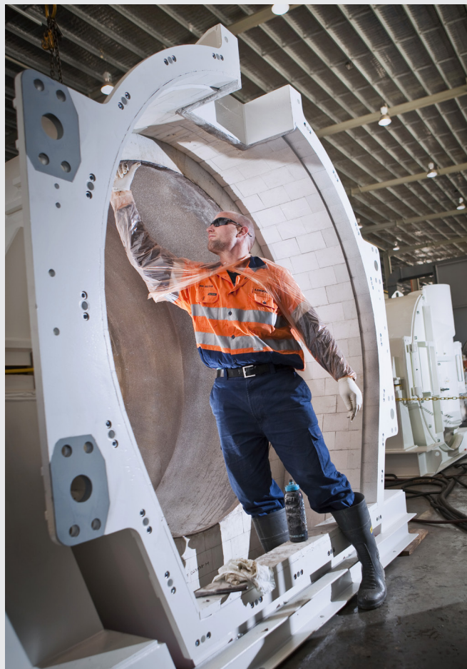
Aplicação de WEAR MAX® à carcaça da centrífuga
