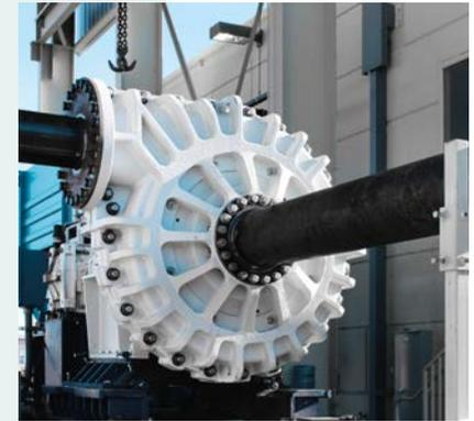
**F**ue el potencial de rentabilidad lo que convenció a la mina de diamantes Kao de implementar la bomba KREBS millMAX™. Después de las conversaciones iniciales, se instaló la primera bomba de prueba – una millMAX 8x6 centrífuga con sello (C/S) – en una aplicación de alimentación de ciclón (DMS 2 bomba 1). Después de siete meses los resultados iniciales indicaban que la millMAX se estaba desempeñando extremadamente bien en el lado de desgaste.
