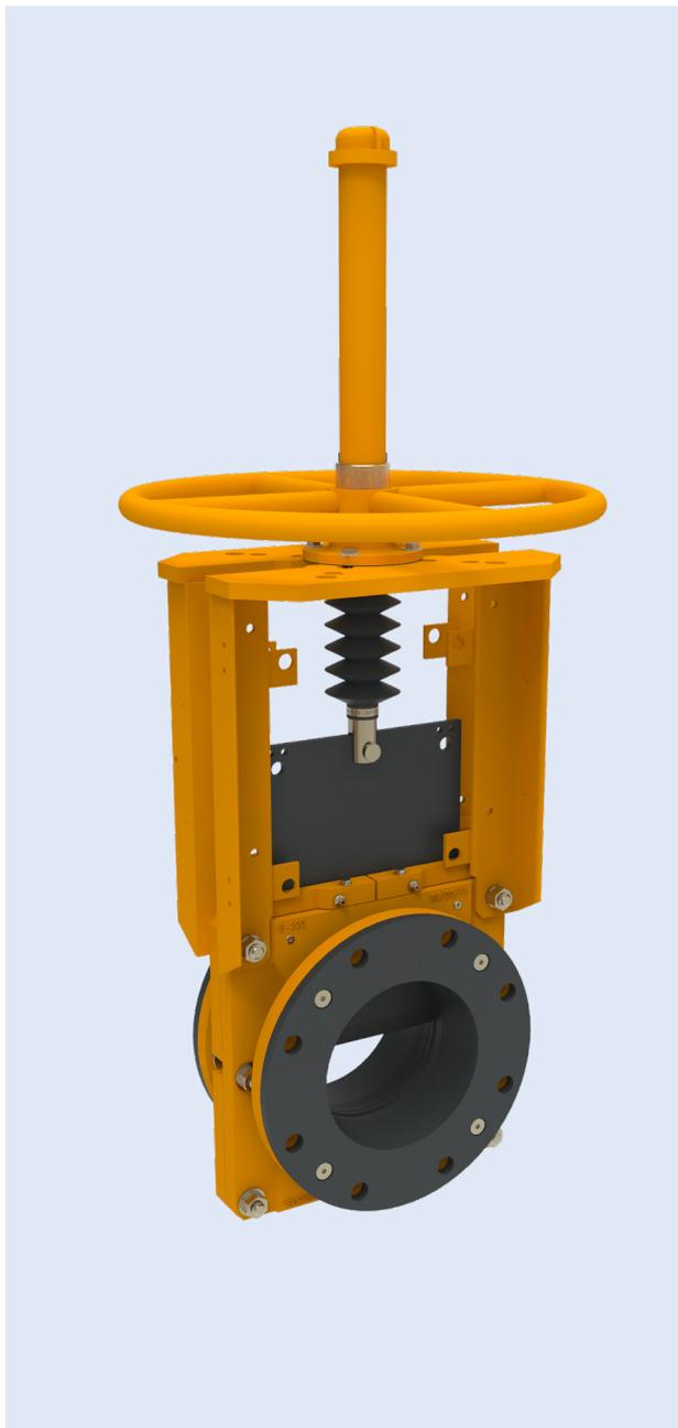
Notre vanne à guillotine Technequip est une véritable vanne à guillotine bidirectionnelle pour la boue avec une conception ouverte et un débit complet. Les manchons en caoutchouc remplaçable sont conçus pour sceller et résister aux conditions sévère et abrasive retrouvées dans l'industrie minière et plusieurs applications de broyage.
