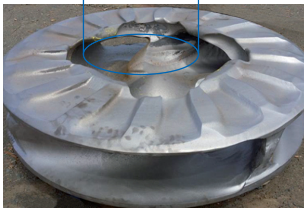
L'oeil de l'impulseur de la pompe d'un concurrent est élargie et déformé, indiquant une recirculation côté aspiration
