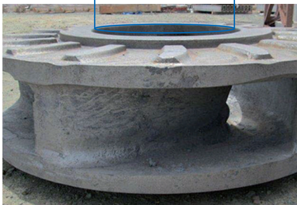
La bague d'usure protège l'oeil de l'impulseur de la pompe contre l'usure due à la recirculation
