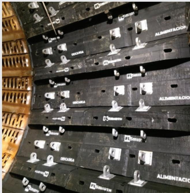
PulpMax Revestimientos de Casco Compuesto
