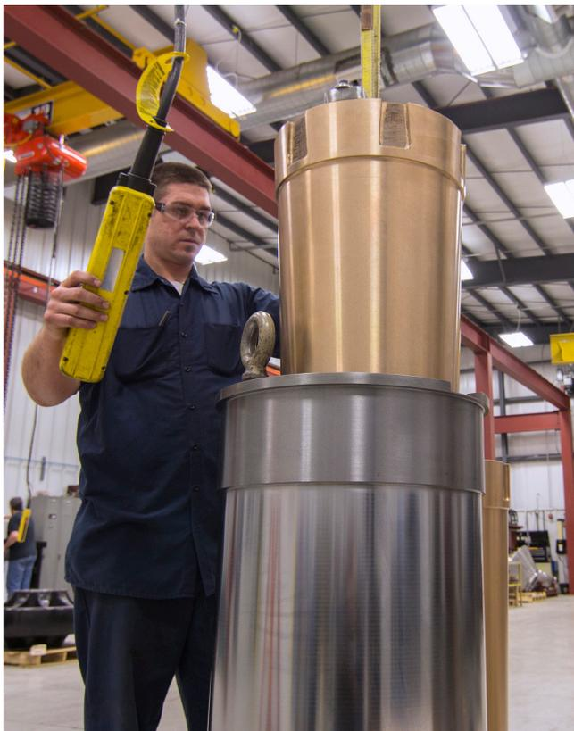
Instalación del buje del excéntrico interior Symons®
